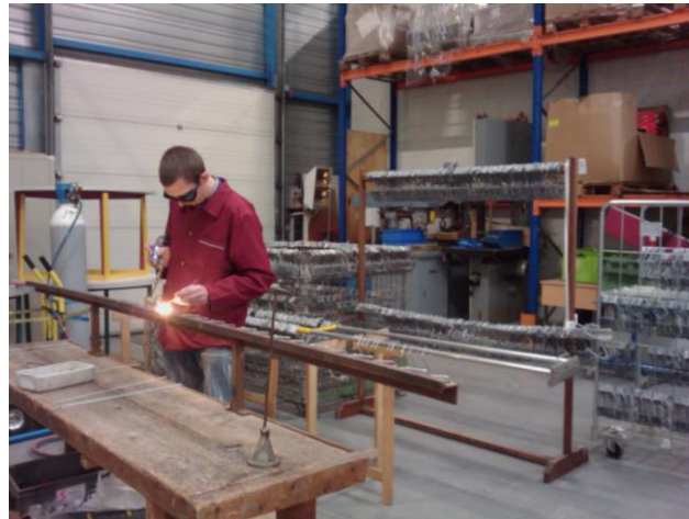
Abrasure de crochets destinés à l'industrie automobile : utilisés pour le maintien des pots d'échappement lors de la mise en peinture
