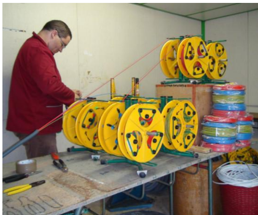
Préfilage et câblage à la demande (gaines et câbles fournis par le client). Réalisations de pieuvres électriques à partir de plans.
