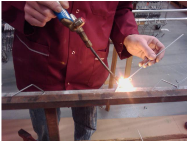
Abrasure de crochets destinés à l'industrie automobile : utilisés pour le maintien des pots d'échappement lors de la mise en peinture
