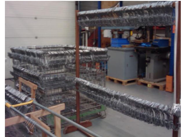
Abrasure de crochets destinés à l'industrie automobile : utilisés pour le maintien des pots d'échappement lors de la mise en peinture
