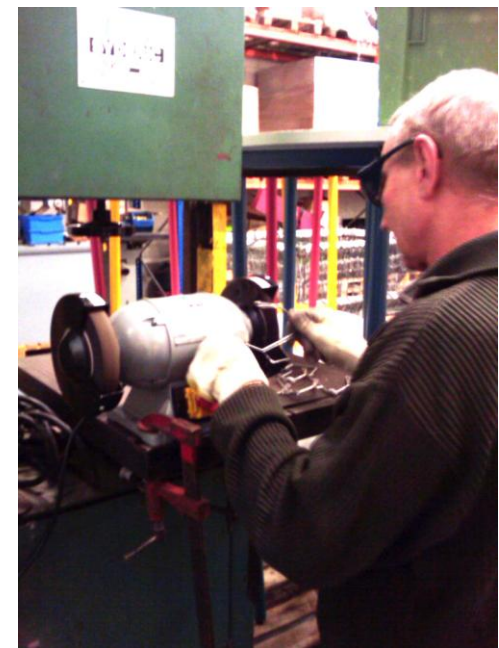
Abrasure de crochets destinés à l'industrie automobile : utilisés pour le maintien des pots d'échappement lors de la mise en peinture
